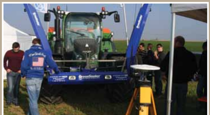
▶ Capteur de biomasse : le GreenSeeker de la marque Trimble, monté sur une rampe avant, permet de moduler les apports pendant l'épandage.
