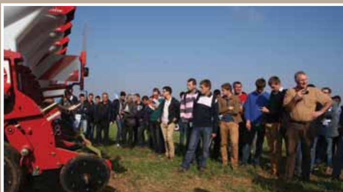
▶ Semoir monograine Kverneland avec coupure des éléments de semis rang par rang.
