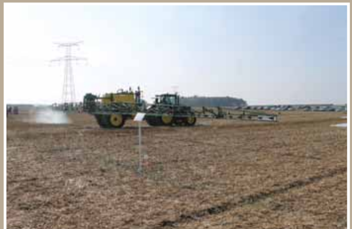
▶ Pulvérisateur John Deere en démonstration de coupe de tronçon pilotée par la cartographie du drone.
