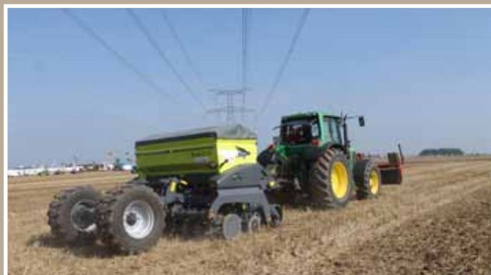
Semoir pour semis direct de chez Sky Agriculture. Modèle Easydrill.
