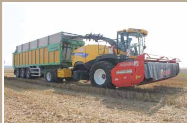
Ensileuse avec coupe à céréales immatures, couplée de semi-remorque pour chantier complet d'ensilage à haut débit.
