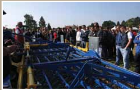
▶ Herse étrille de marque Treffler. Sa particularité : un réglage depuis la cabine de l'agressivité de dents. De plus, la culture est moins endommagée grâce au système d'amortissement des dents montées sur ressort.
