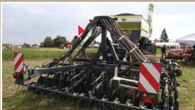
▶ Semoir Sky Maxi Drill qui offre une autonomie importante, cloisonnement de trémie et possibilité de fertilisation.
