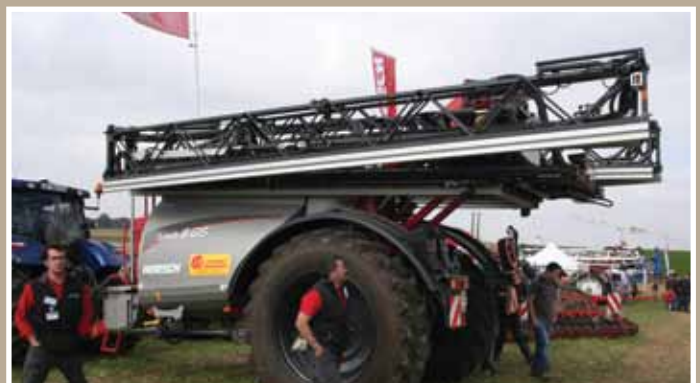
▶ Nouveau venu dans le secteur de la pulvérisation : le Horsch Leeb 665, équipé d'une buse tous les 25 cm, permettant de réduire la distance entre rampe et cible.
