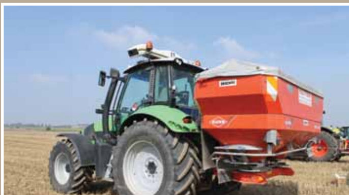
Semoir à engrais avec débit proportionnel à l'avancement et pesée embarquée. Barre N-Sensor (Yara) munie de caméras sur la cabine.
